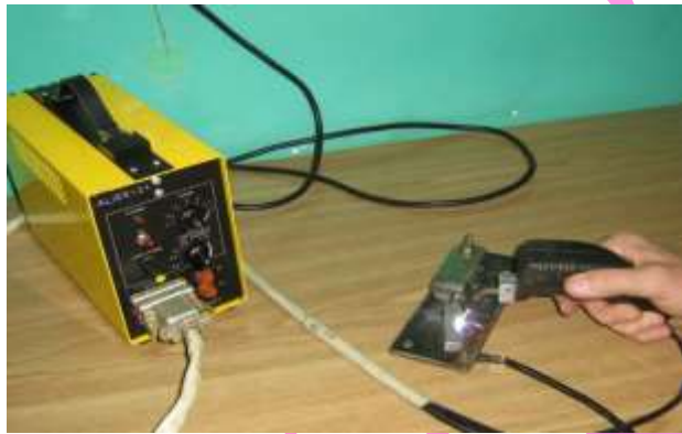
Рисунок 2.1. Установка для електроіскрового легування ALIER31
